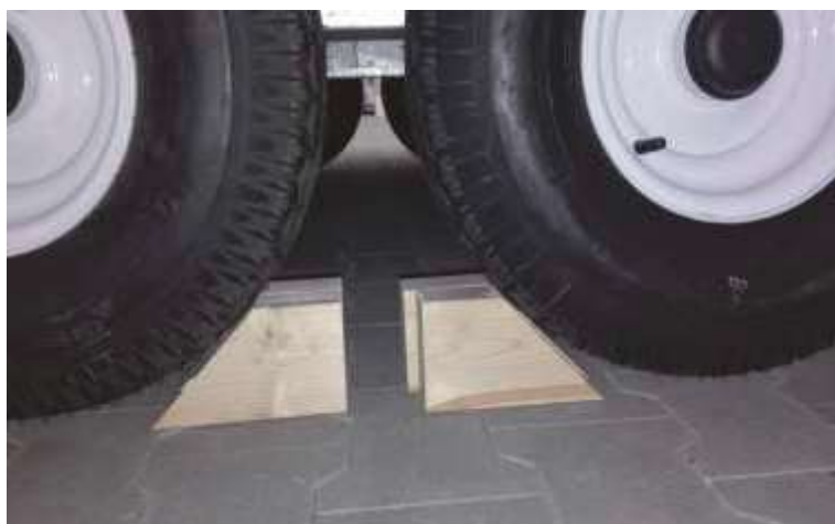
Prawidłowe umieszczenie klinów przy kołach domu mobilnego.
